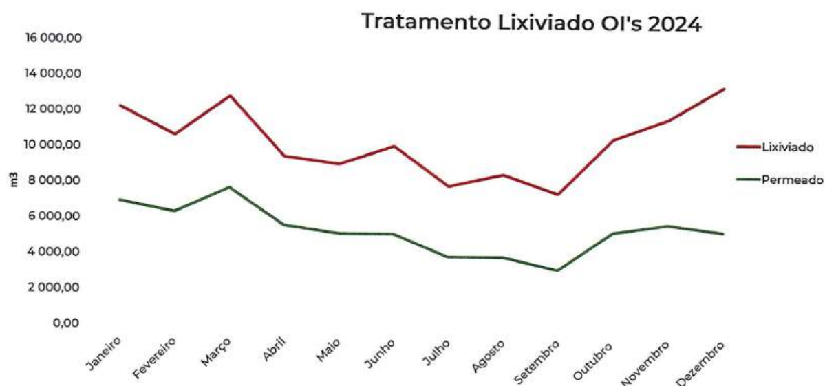
Gráfico 11 - Representação da relação entre o lixiviado e a quantidade de efluente permeado produzido.
