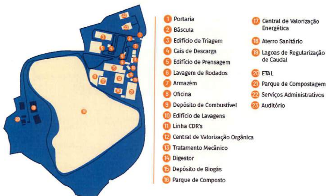
Figura 6 – Esquema ilustrativo do CTRSU de Tondela
